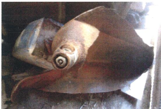
8 月 21 日には姫路市家島の倉庫で保管中の酸素容器が突然破裂し、火災が発生しました。破裂した容器は 40 年以上前のものであり、少なくとも 10 年以上前に購入された容器が、倉庫に長期に保管されたまま腐食して破裂したものとみられています。
